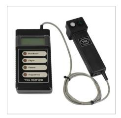
Люксметр ТКА-ПКМ-09 предназначен для измерения коэффициента пульсации источников излучения, яркости протяжённых самосветящихся объектов накладным методом (экранов мониторов) и освещённости в видимой области спектра (380...760) нм, с выводом информации на ПК.
