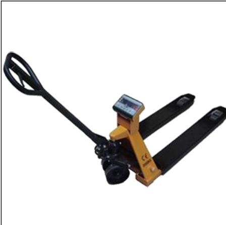
Весовая тележка (гидравлическая тележка с весами, рохла с весами, рохла с весами) - это обычная тележка для транспортировки грузов, установленных на паллетах, снабженная весоизмерительными сенсорами и индикатором. Весовые тележки гидравлические могут применяться в тех случаях, когда при перегрузке грузов, размещенных на паллетах, возникает необходимость контролировать массу этих грузов.
