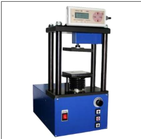
Прессы малогабаритные ПМ-МГ4 предназначены для испытаний образцов из пенополистирола, пенопластов, минераловатных плит и других теплоизоляционных материалов по ГОСТ 15588, 20916, 22950, 2694, 9573 на сжатие при 10 % линейной деформации и на изгиб.
