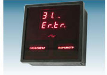
Рис. 9. Сигнализатор MC-K-500-2C выполнен в специальном пластиковом корпусе для врезки в щит. Кнопки управления – сенсорные (емкостные). Тумблер защиты настроек расположен на задней панели.
