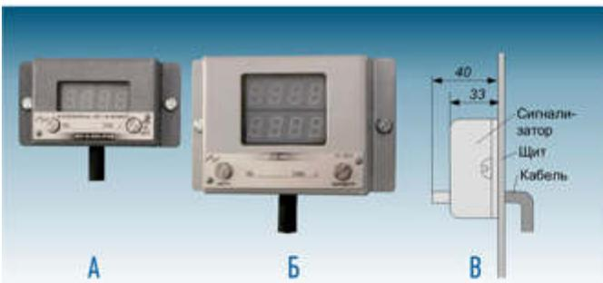
Рис. 13. Сигнализаторы BC-K-500 (А) и BC-K-500-2 (Б) поставляются с кабелем длиной 1,5 м (или другой длиной под заказ). Возможно исполнение с кабелем, выходящим из задней панели корпуса, предназначенным для монтажа сигнализатора на щите (В). Панель сигнализатора BC-K-500 (В) может иметь надпись измеряемого параметра ("Уровень", "Температура"... - по заказу) для размещения на щите нескольких сигнализаторов с индивидуальной индикацией одного измеряемого параметра.
