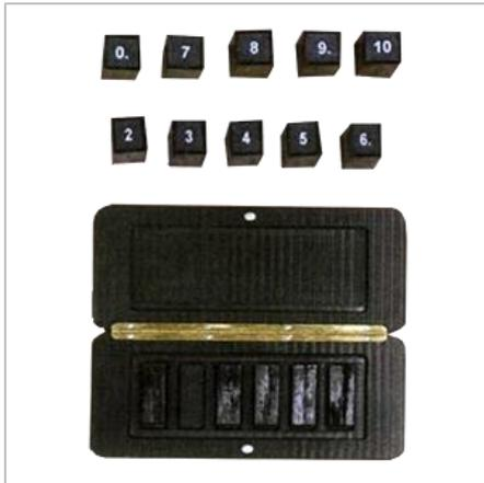
Наборы стеклянных мер оптической плотности НОСМОП-7 используются в качестве средства измерений при поверках фотометров, предназначенных для измерения оптической плотности биологических и других прозрачных жидкостей в стандартных кварцевых и стеклянных кюветах с длиной оптического пути 10 мм и работающих в диапазоне длин волн от 339,0 до 343,0 и от 400 до 800 нм.
