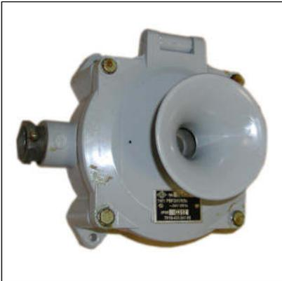
Ревун серии «РВП» предназначен для подачи звукового сигнала в системах тревожной сигнализации переменного тока. Приборы изготавливаются в двух климатических исполнениях по ГОСТ 15150-69: О1 (общеклиматическое исполнение) и УХЛ5 (для эксплуатации в макроклиматических районах с умеренным климатом и холодным климатом).
