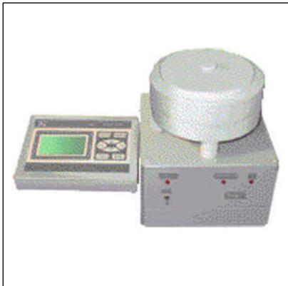
Установка «АСТ-2М» предназначена для контроля качества трансформаторного масла (ТМ) по параметру «tg d» с микропроцессорным управлением работы. Конструктивно АСТ-2М состоит из двух блоков. Нагреватель, термостат, испытательная ячейка с ТМ, высоковольтный источник и первичные датчики температуры ТМ и tg d размещены в блоке испытательном технологическом (БИТ). Основным элементом блока измерения и управления (БИУ) является микропроцессор, задающий АСТ-2М программно-управляемый режим работы.
