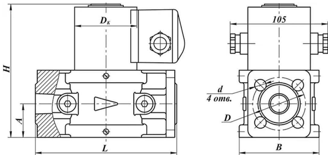
Габаритные и присоединительные размеры клапанов фланцевых DN 25-100
