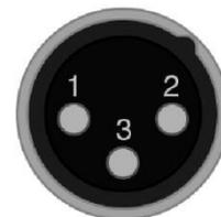
Нумерация контактов разъема типа XLR 3 Cannon, штырь. Вид со стороны штыревых контактов
