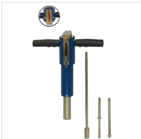
Статический плотномер СПГ-1М предназначен для ускоренного операционного контроля качества уплотнения грунтов земляного полотна и дополнительных слоев оснований автомобильных дорог, аэродромов и прочих земляных сооружений.
