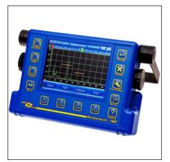
Портативный, ультразвуковой дефектоскоп общего назначения ИНТРОТЕСТ-1МН предназначен для обнаружения дефектов типа несплошностей в различных материалах, изделиях и сварных соединениях. Дефектоскоп позволяет измерять координаты дефектов и толщину стенки.
