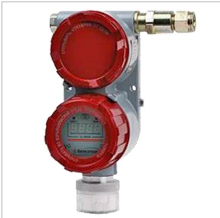
Инфракрасные датчики-газоанализаторы ДАК ИБЯЛ.418414.071-06...038 предназначены для непрерывного автоматического измерения дозврывоопасных концентраций метана (СН<sub>4</sub>), углеводородов, в том числе паров нефти и нефтепродуктов, попутного нефтяного газа, спиртов, а также объемной доли диоксида углерода (СО<sub>2</sub>).
