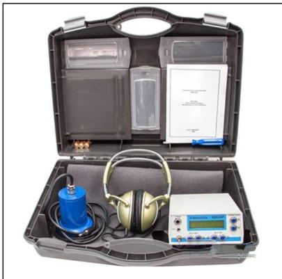
Течейскашель «Квazar» осушествляет поиск мест утечек жидкостей и газов из трубопроводов или резервуаров (в том числе подземных), утечек в запорной аппаратуре, засоров трубопроводов. Благодаря специальной конструкции акустического датчика его можно использовать как наземный геомикрофон на твердых или рыхлых поверхностях.
