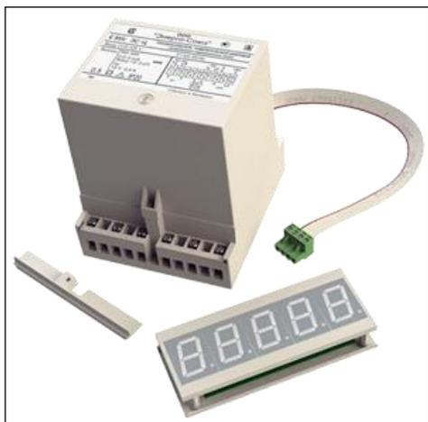
Измерительные преобразователи E855ЭС-Ц предназначены для линейного преобразования входного сигнала напряжения переменного тока, передачи результатов преобразования с использованием порта RS-485, отображения результатов измерения на выносном пятиразрядном показывающем устройстве, а также для преобразования входного сигнала в унифицированный выходной сигнал постоянного тока.
