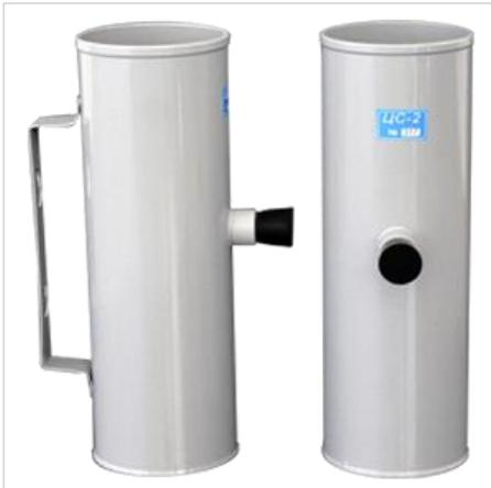
Цилиндр стабильности ЦС-2 предназначен для определения показателя стабильности бурового раствора.
