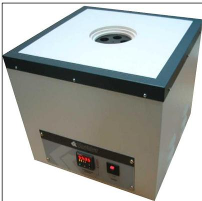
Прибор **ЛКН-М** предназначен для инструментального обеспечения определения коксуемости нефтепродуктов по ГОСТ 8854 и соответствует методике, регламентированной стандартом ASTM D 524 (метод Рамсботтома).
