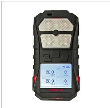
Газоанализатор ЛИДЕР-041 позволяет осуществлять непрерывный автоматический контроль содержания токсичных газов, летучих органических соединений (ЛОС), кислорода и горючих газов в атмосфере и выдает оповещение об опасных уровнях концентрации: звуковой сигнал, мигающие светодиодные индикаторы и встроенный вибросигнал.
