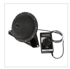
Прибор предназначен для измерения полного светового потока светодиодов по методу "интегрирующей сферы" ("Сферы Ульбрихта"), в люменах.
