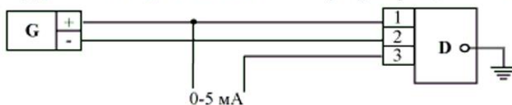
в) Датчик с выходным сигналом 0 - 5 мА, 3-проводная линия
