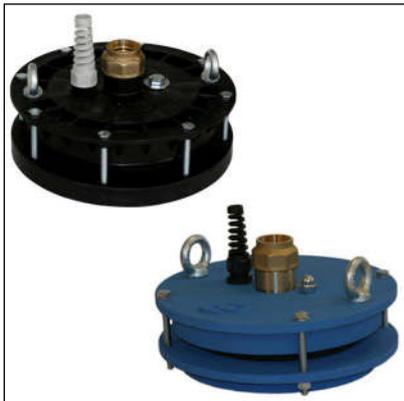
Оголовок скважины «ОС» предназначается для герметизации устья скважины. Наружный диаметр обсадной трубы 107 - 152 мм. Внутрь обсадной трубы устанавливается насос, имеющий полиэтиленовую напорную трубу с диаметром 32 и 40 мм., кабели круглого сечения в оболочке:
