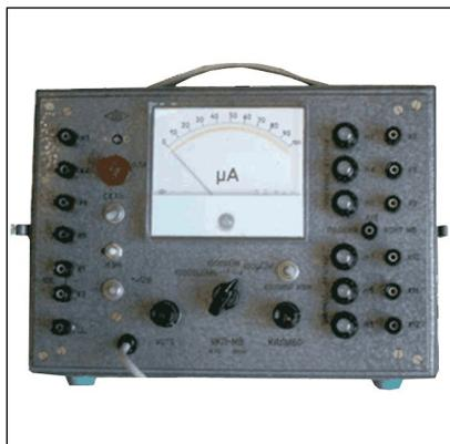
Устройство **УКП-МВ** предназначено для контроля параметров выключателя во время ремонта.
