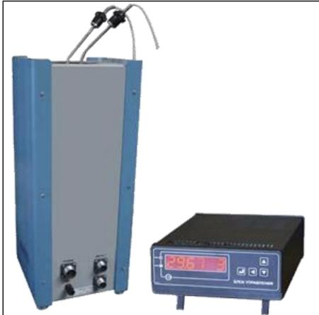
Термостат сухой ТС 600-2 предназначен для нагрева средств измерения температуры в диапазоне от 50 до 600°C в лабораторных и цеховых условиях:
