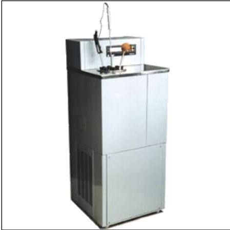
Криостат КР-40-2 предназначен для поверки и исследования средств измерения температуры в лабораторных условиях.
