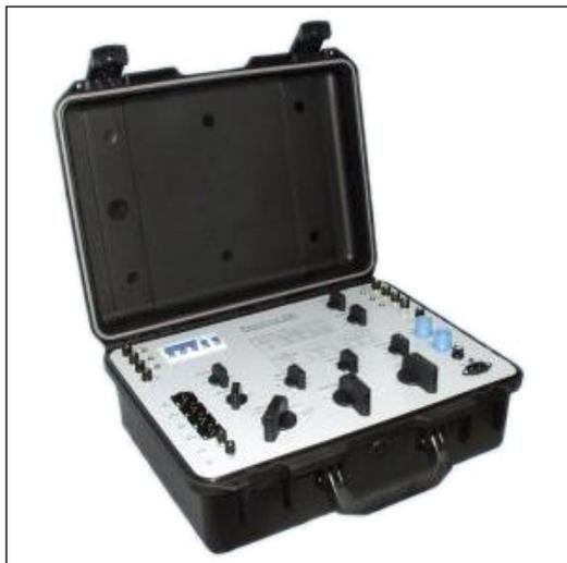
Комплект "Вектор-К-63" предназначен для организации измерений диэлектрических параметров изоляции как в одно-, так и в многопроводной (многофазной) сети и позволяет:
