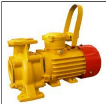
Электронасос «КМ 50-32-125Е» предназначается для перекачивания из одной среды в другую нефтепродуктов. Температура продукта должна быть в диапазоне от -40 до 50 °С, вязкость – до 10<sup>-4</sup> м<sup>2</sup>/с (100 сСт). Количество содержащихся твердых взвешенных частиц в перекачиваемом продукте не должно превышать 0,2%, а их размер – 0,2 мм.
