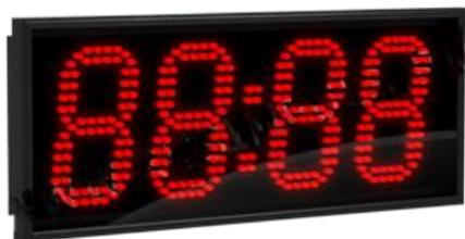
Электронные часы Импульс-413-SS являются вторичными (ведомыми) часами в системах часофикации по принципу «МАСТЕР-ВЕДОМЫЙ». Ведомые часы отображают время в соответствии с сигналом, полученным от Мастер-часов.
