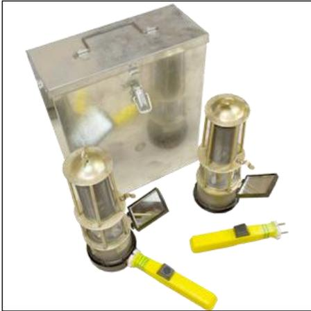
Лампа ЛБВК М ЭЗ является газобезопасной бензиновой лампой и предназначена для обнаружения (индикации) загазованности воздушной среды в водопроводных, канализационных, теплофикационных, телефонных смотровых колодцах и в камерах с вредным содержанием сероводорода, угарного газа и взрывоопасной углеводородной концентрацией газов.
