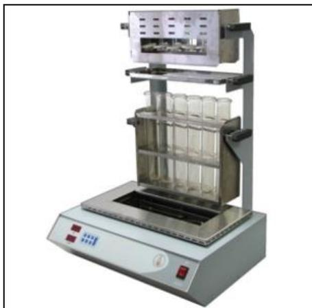
Универсальная автоматическая установка для разложения по Кьельдалю LOIP LK-100 (Терморектор) предназначена для подготовки проб методом быстрого инфракрасного разложения для анализа содержания азота в органических соединениях по методу Кьельдаля. Установка может работать с самым широким спектром образцов. Время разложения предельно сокращено благодаря минимальной инерционности нагрева и охлаждения.
