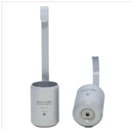
Погружной чашечный вискозиметр Elcometer-2437/2 предназначен для быстрого измерения вязкости на месте проведения работ или в процессе производства. Измеряемая кинематическая вязкость обычно выражается в секундах времени истечения, которые могут быть переведены в единицы сантиСтокс.
