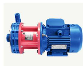
Во избежание выхода из строя центробежного химически стойкого электронасосного агрегата на всасывающем трубопроводе следует установить фильтр для насоса с целью очистки перекачиваемых сред от механических примесей. Фильтроэлементы устанавливаемых перед центробежными насосами фильтров имеют ячейки - 0,2...0,25 мм, а площадь фильтрующей поверхности, обеспечивающей трёхкратную номинальную подачу, составляет:
