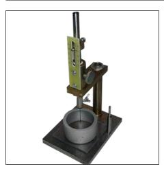
Прибор Вика ОГЦ-1 предназначен для определения нормальной густоты и сроков схватывания цементного теста по ГОСТ 310.3-76.
