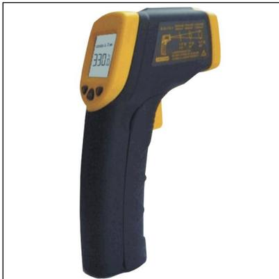
Инфракрасный термометр **AR330** осуществляет бесконтактное измерение температур в диапазоне от  $-32^{\circ}\text{C}$  до  $+330^{\circ}\text{C}$  с точностью  $\pm 2^{\circ}\text{C}$ .
