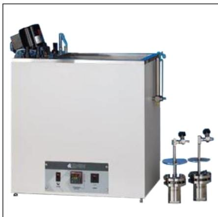
Корпус термостата К-10991 представляет собой полностью изолированную сварную конструкцию, оснащённую встроенной поддерживающей стойкой для бомб и расширительным резервуаром со сливным патрубком, обеспечивающим погружение бомб на требуемую рабочую глубину. Внутренние стенки термостата изготовлены из нержавеющей стали, наружные стальные стенки защищены коррозионностойкой полиуретановой эмалью.
