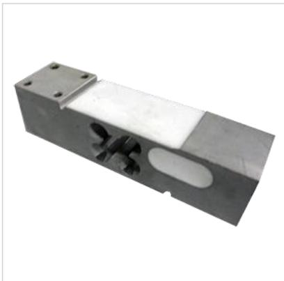
Одноточечные датчики К-О-10А предназначены для измерения малых нагрузок и используются при изготовлении платформенных весов, дозаторов, фасовочного оборудования. Датчик при этом является единственным в конструкции и располагается под центральной частью платформы.
