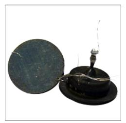
Счетчик Гейгера-Мюллера предназначен для работы в дозиметрических различных радиометрических устройствах.
