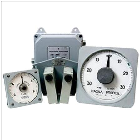
Тахометры «К1803.1» предназначены для измерения частоты вращения реверсивных и нереверсивных валов диаметров от 20 до 1125 мм. Класс точности при работе с реверсивными валами 1,0; при работе с нереверсивными валами 1,5. Диапазоны показаний тахометров, работающих с роторами, установленными на основных валах, а также конечные значения частот сигналов первичных преобразователей тахометров (Fк), (в зависимости от числа зубьев) указаны в таблице 1.
