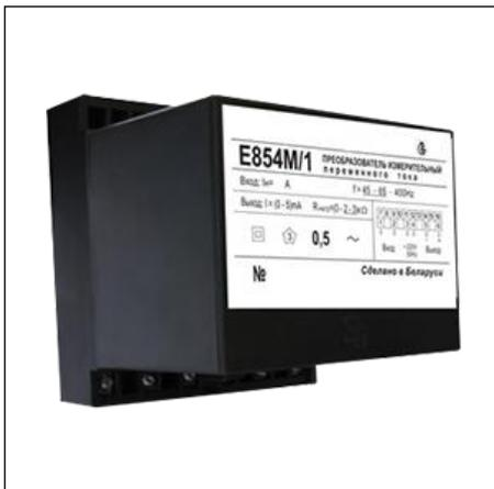
Измерительный преобразователь переменного тока Е854М предназначен для линейного преобразования действующего (среднеквадратичного) значения переменного тока в унифицированный электрический сигнал постоянного тока. Информацию несет среднее значение выходного сигнала.
