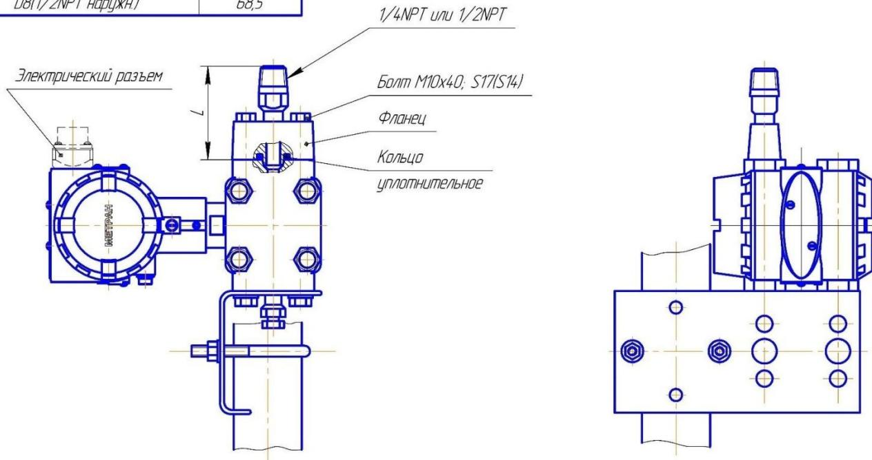
**Рис. 4. Датчики модели 150CG с установленным монтажным фланцем с резьбовым отверстием K1/4" (код D1), или K1/2" (код D2), или 1/4NPT (код D3), или 1/2NPT (код D4) и монтажным кронштейном для установки на двухдюймовой трубе (код B1 или B4)**
