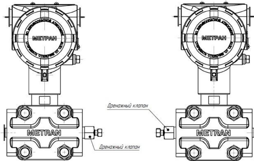
Базовое расположение дренажного клапана
