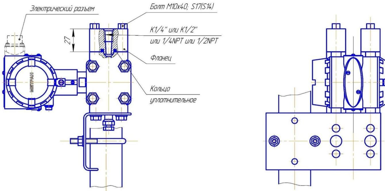
**Рис. 9. Датчики моделей 150TG, TA с установленным ниппелем (коды 2F, 2H) и монтажным кронштейном для установки на двухдюймовой трубе или панели (код B4) и установки на панели (код B1)**
