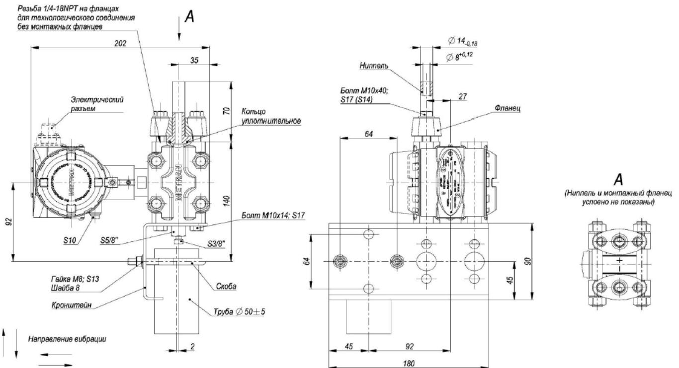
**Рис. 2. Датчики модели 150CG с установленным ниппелем под накидную гайку M20x1,5 (коды D5, DA) и монтажным кронштейном для установки на двухдюймовой трубе (код В1 или В4)**
