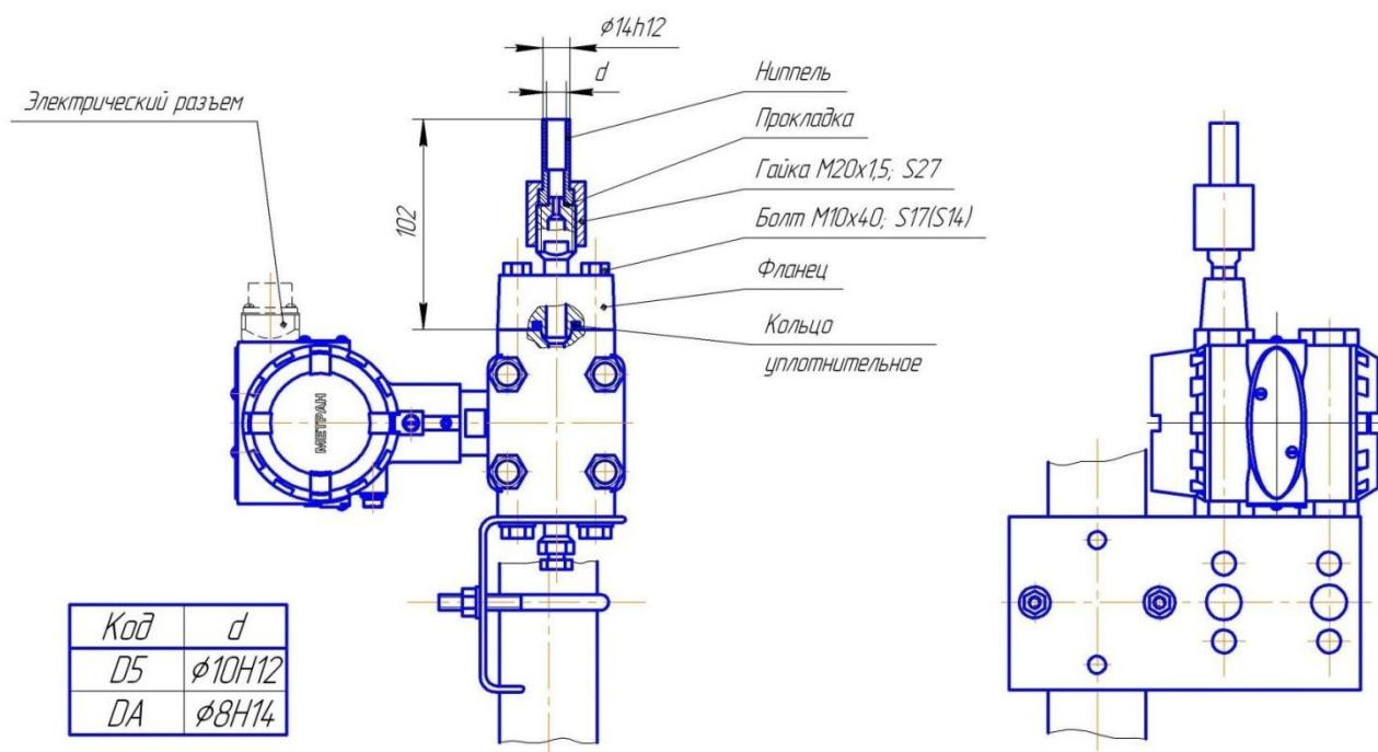
**Рис. 3. Датчики модели 150CG с установленным монтажным фланцем со штуцером 1/4NPT (код D7) или 1/2NPT (код D8) и монтажным кронштейном для установки на двухдюймовой трубе (код B1 или B4)**
