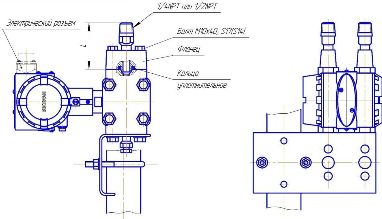
**Рис. 8. Датчики модели 150CD с установленными монтажными фланцами с резьбовым отверстием K1/4" (код D1), или K1/2" (код D2), или 1/4NPT (код D3), или 1/2NPT (код D4) и монтажным кронштейном для установки на двухдюймовой трубе (код В1 или В4)**
