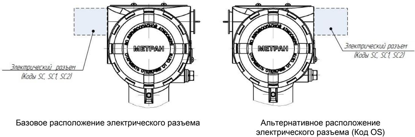
Базовое расположение электрического разъема
