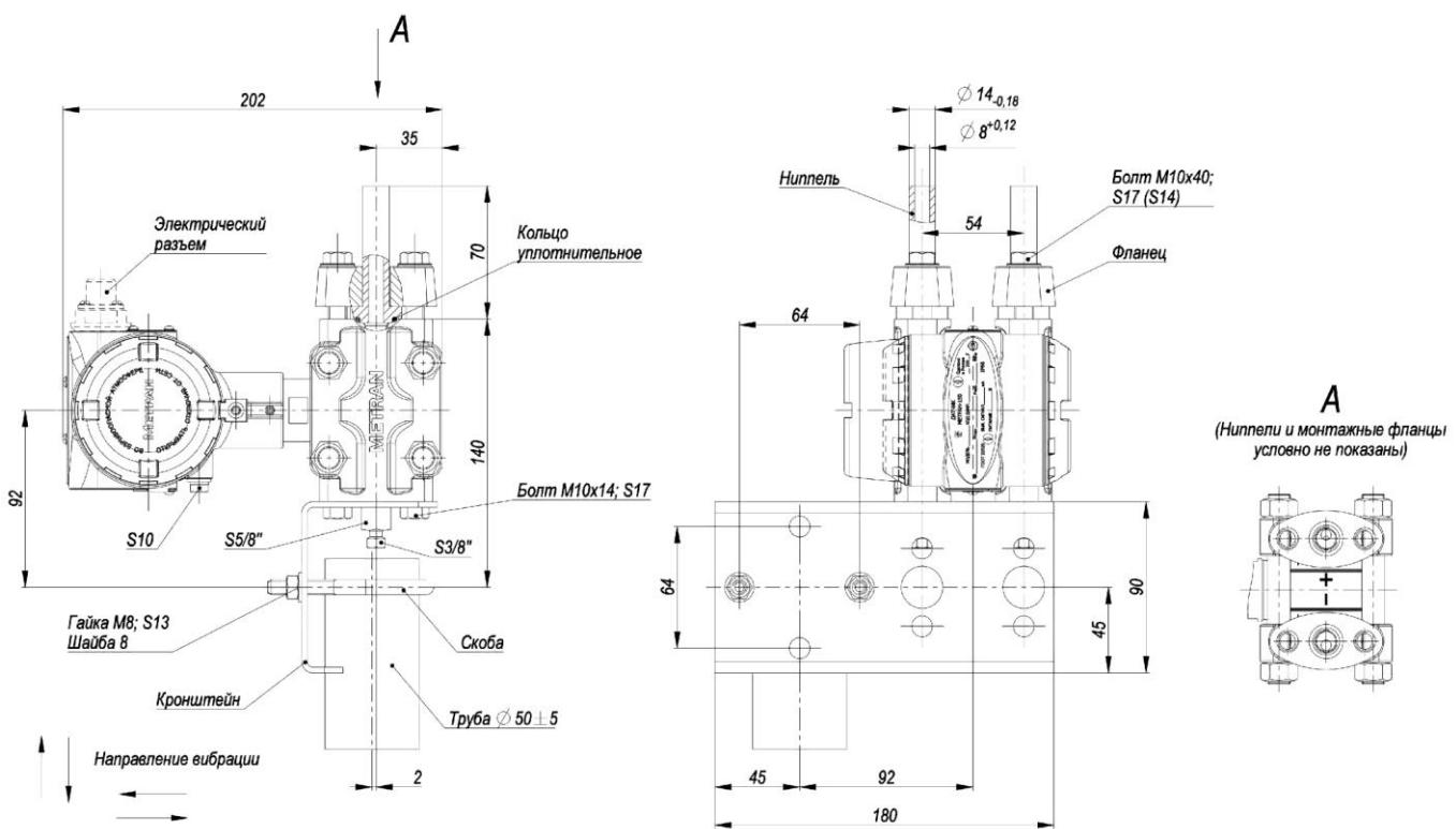
Рис. 6. Датчики модели 150CD с установленными ниппелями под накидные гайки M20x1,5 (коды D5, DA) и монтажным кронштейном для установки на двухдюймовой трубе (код В1 или В4)
