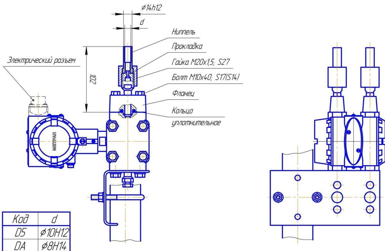
**Рис. 7. Датчики модели 150CD с установленными монтажными фланцами со штуцером 1/4NPT (код D7) или 1/2NPT (код D8) и монтажным кронштейном для установки на двухдюймовой трубе (код В1 или В4)**
