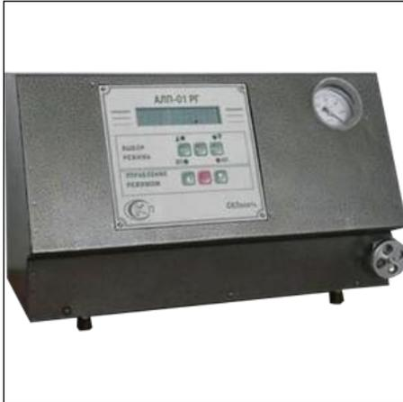
Предназначен для измерения в полуавтоматическом режиме количества растворенного газа, выделяющегося из нефти в свободное состояние при различных давлениях и температурах.
