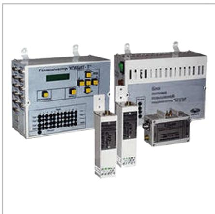
Предназначен для контроля недостаточного или избыточного содержания кислорода, опасной загазованности горючими или токсичными газами в воздухе рабочей зоны и сигнализации о выходе содержания определяемых газов за допустимые пределы. Взрывозащищенное исполнение блоков датчиков, с маркировкой взрывозащиты ExibIIBT6.
