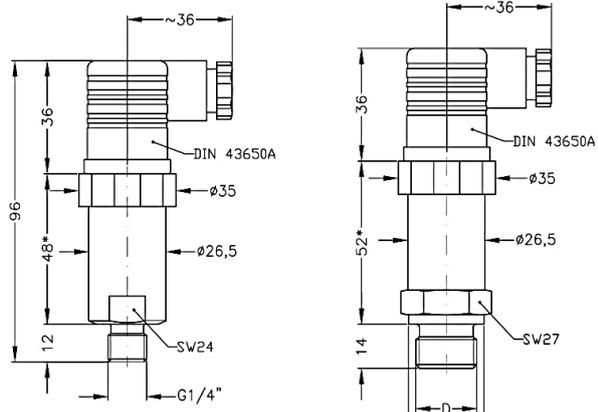
(\*Датчики с ВПИ больше чем 40 бар и датчики с кодом исполнения 01R длиннее на 5 мм.
