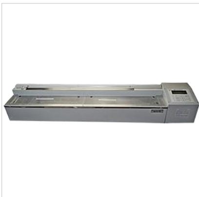
Аппарат ДА-03 предназначен для определения максимального усилия при растяжении и максимальной длины, на которую может растянуться без разрыва битум, залитый в специальную форму, раздвигаемую с постоянной скоростью при заданной температуре по ГОСТ 33138-2014.
