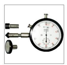
Тахометр часовой ТЧ-10Р (в дальнейшем - тахометр) обыкновенного исполнения, класса точности 1,0 предназначен для измерения частоты вращения частей машин и механизмов, имеющих центровочные элементы, и линейных скоростей способом непосредственного присоединения.
