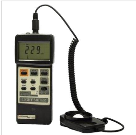
Люксметр АТТ-1505 предназначен для измерения освещенности от источников света различного типа: дневного света, ламп накаливания с вольфрамовой нитью, флуоресцентных ламп, ламп дневного света, ртутных ламп.
