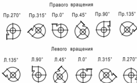
Положения корпуса вентилятора (со стороны входа)
