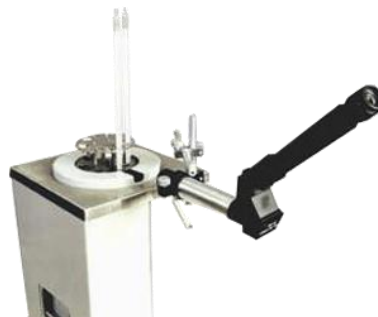
ТР-1М термостат с кассетой для поверки ртутных термометров с видеоискателем
