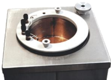
ТПВ-2 устройство для поверки поверхностных датчиков температуры
