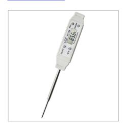
Контактный термометр DT-133A предназначен для измерения температуры с лабораторной точностью. Имеет возможность переключения между единицами измерения температуры °C и °F, оснащен функциями показаний текущей температуры и отображения максимального/минимального значения температур. Поставляется с защитным чехлом.
