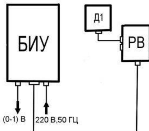
Каждый датчик представляет собой две параллельные металлические полосы, образующие конденсатор, и измерительный блок. Изменение электрической емкости конденсатора (датчика) функционально связано с изменениями величины влажности контролируемой культуры. Измерительный блок датчика (Д1) преобразует значения емкости конденсатора в сигнал измерительной информации, который по соединительному кабелю через расширитель входа (РВ) передается в блок индикации и управления (БИУ).
