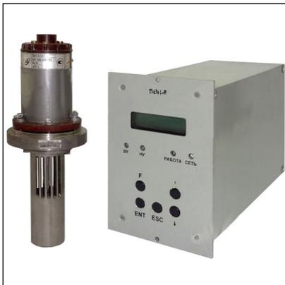
Вискозиметр вибрационный низкочастотный **ВВН-8** предназначен для измерения вязкости жидкостей, выпускается в пяти исполнениях в зависимости от диапазона измерения и может быть использован для автоматизации аналитического контроля в технологических процессах и создания АСУ ТП.
