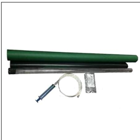
Тест-комплект «Мутность/прозрачность» предназначен для экспрессного определения мутности и прозрачности питьевой, природной и нормативно-очищенной сточной вод в полевых, лабораторных, и др. условиях.
